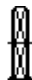
Figura 37. Símbolo que representa a un sensor de semillas o de fertilizantes desconectado del cableado.
